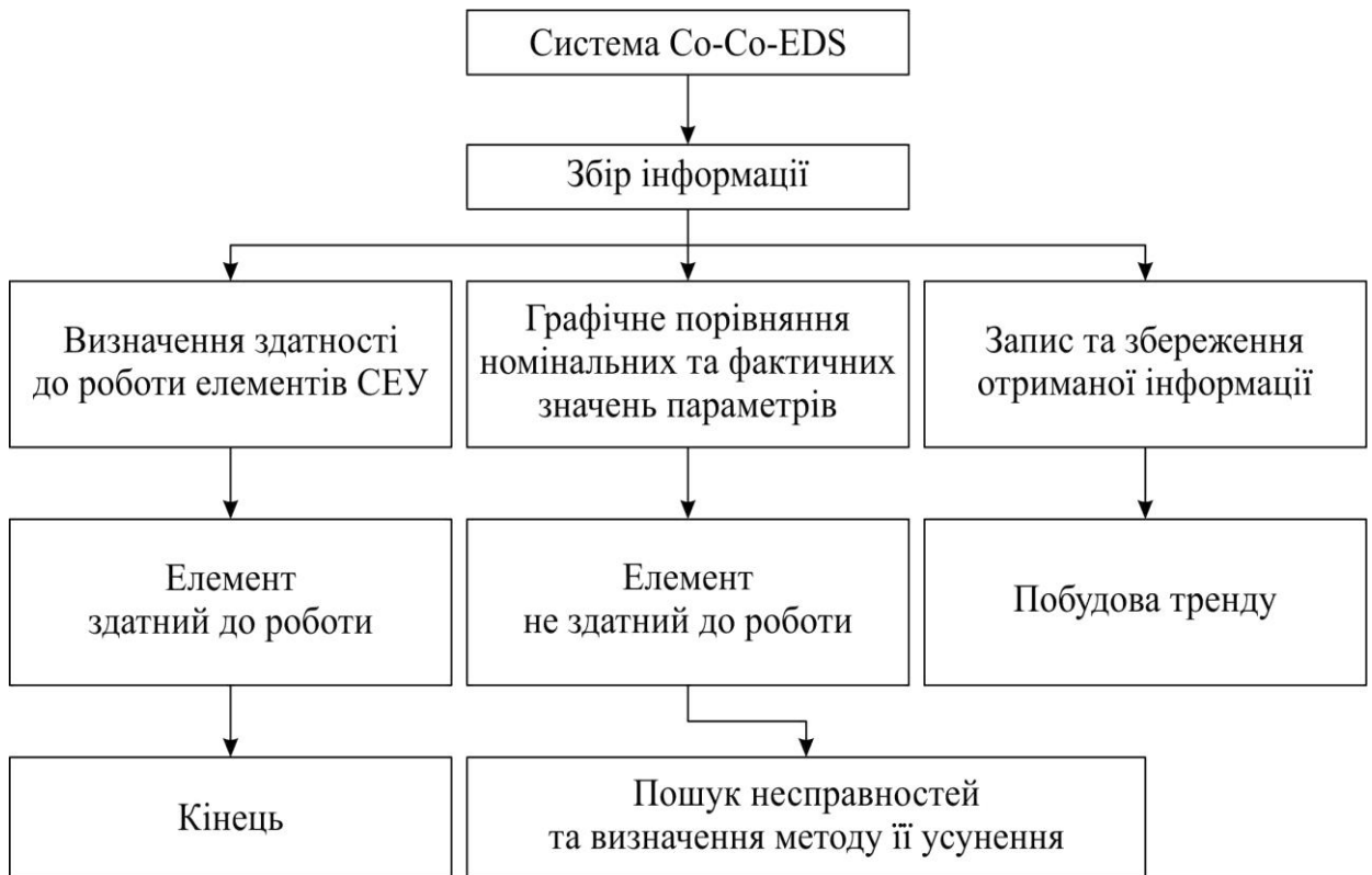
Рис. 4.3. Блок схема алгоритму системи діагностики Co-Co-EDS
