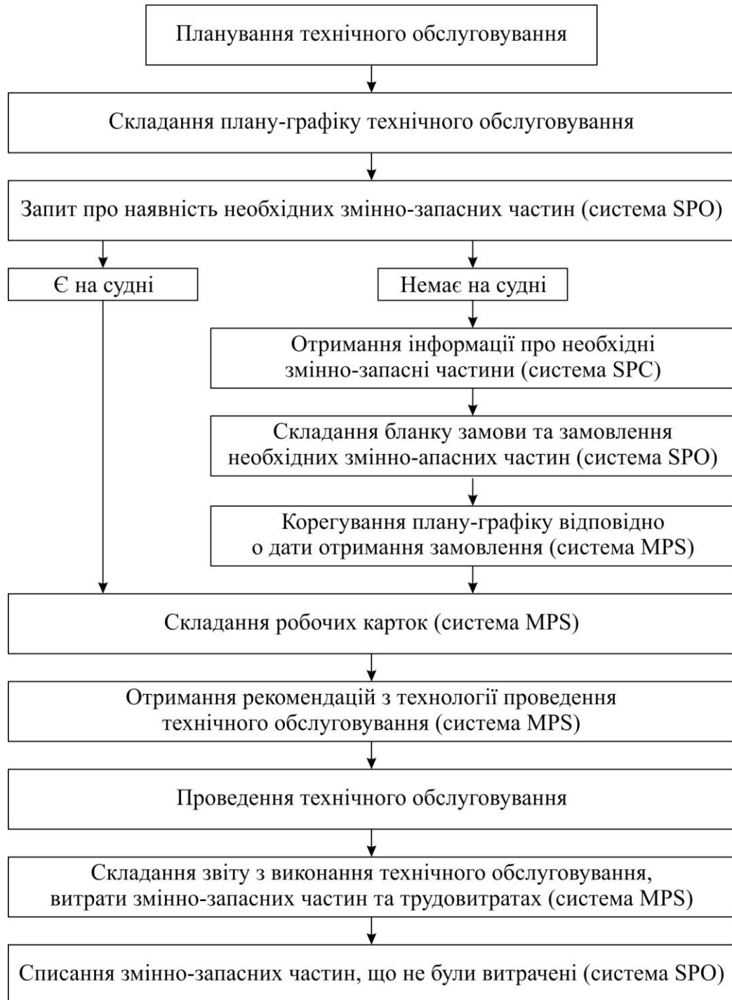
Рис. 4.5. Використання системи Co-CoS при виконанні планового ТО
