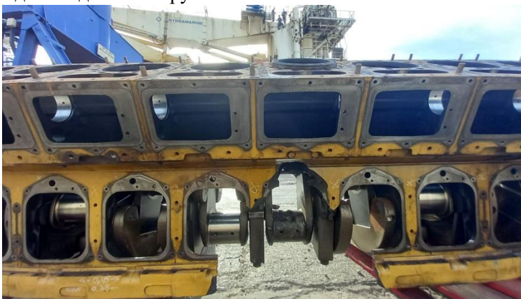
Рис.1 Аварійний випадок пов'язаний із поломкою ділянки колінчастого вала суднового двигуна.
