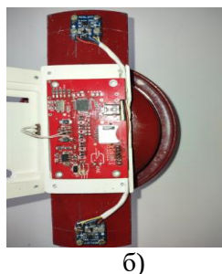
Рис. 2. Блок-схема (а) та зовнішній вигляд вимірювального пристрою (б): 1,2 – трьохосьові акселерометри; 3- трьохканальний суматор; 4- дatalogер; 5- фотодатчик; 6-одноканальний підсилювач сигналу; 7 – SD-носії; 8 – джерело світла
