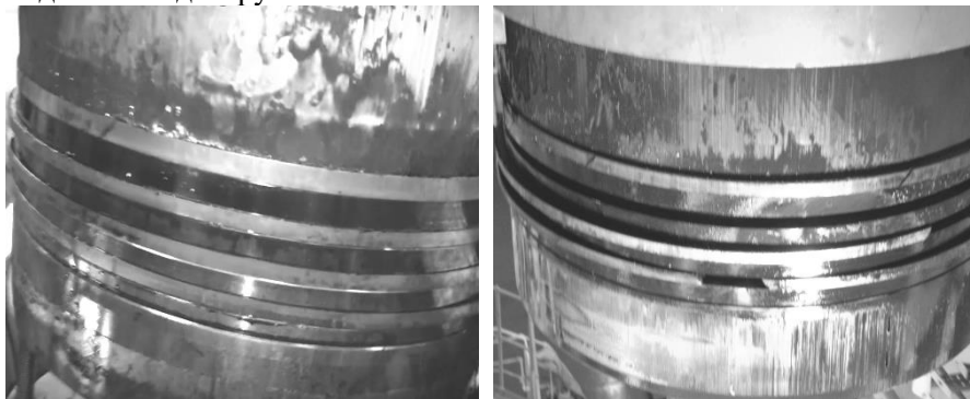
Рис.1. Відкладення на боковій поверхні головки поршня
