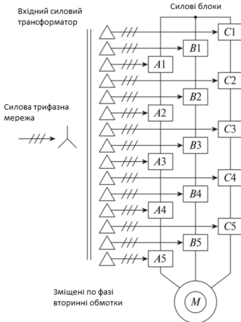
Рисунок 2.6 - Схема багаторівневого каскадного перетворювача частоти
