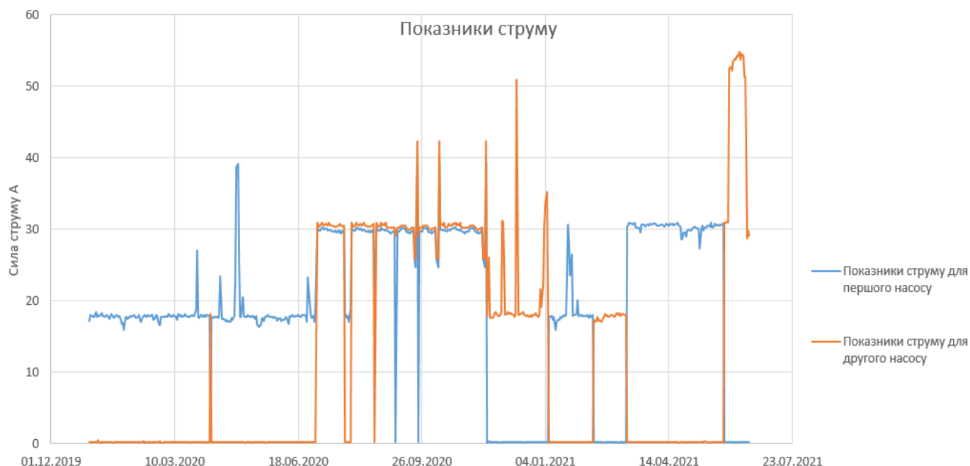
Рисунок 4.16 – Показники струму на виході з VFD.
