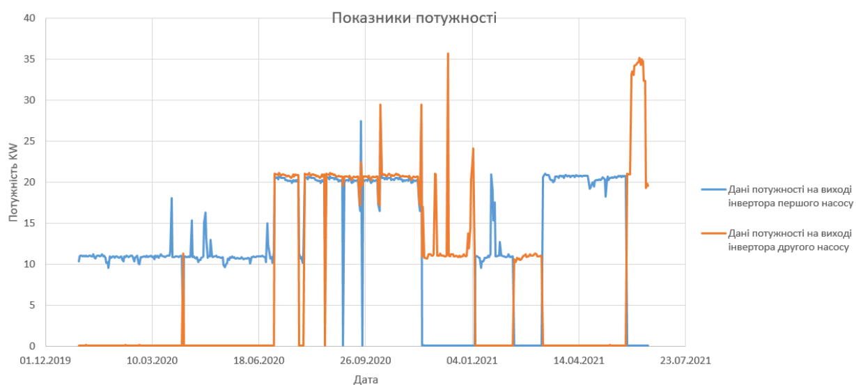
Рисунок 4.15 – Показники потужності на виході з VFD.
