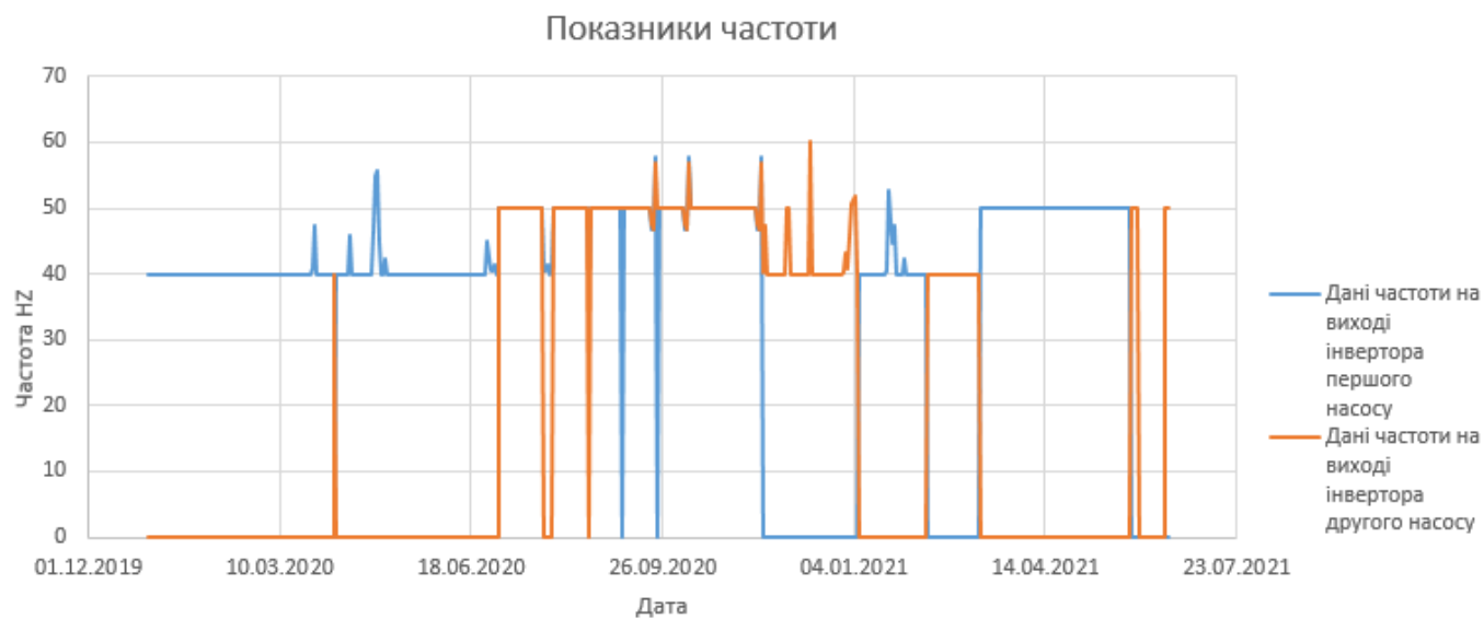
Рисунок 4.14 – Показники частоти на виході з VFD.
