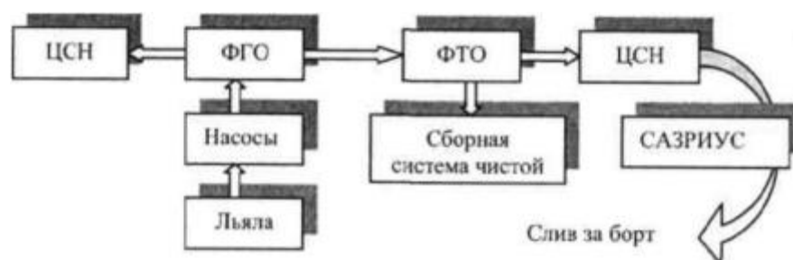
Рис. 5.1. Схема двоступеневої очистки забруднених вод (ЦСН - цистерна стічних нафтопродуктів; ФТО - фільтр тонкого очищення; ФГО - фільтр грубого очищення; САВРІУС - система автоматичного виміру, реєстрації та управління скиданням)
