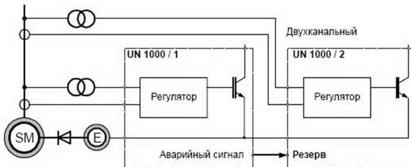
Рисунок 2.8 – Двуканальна система
