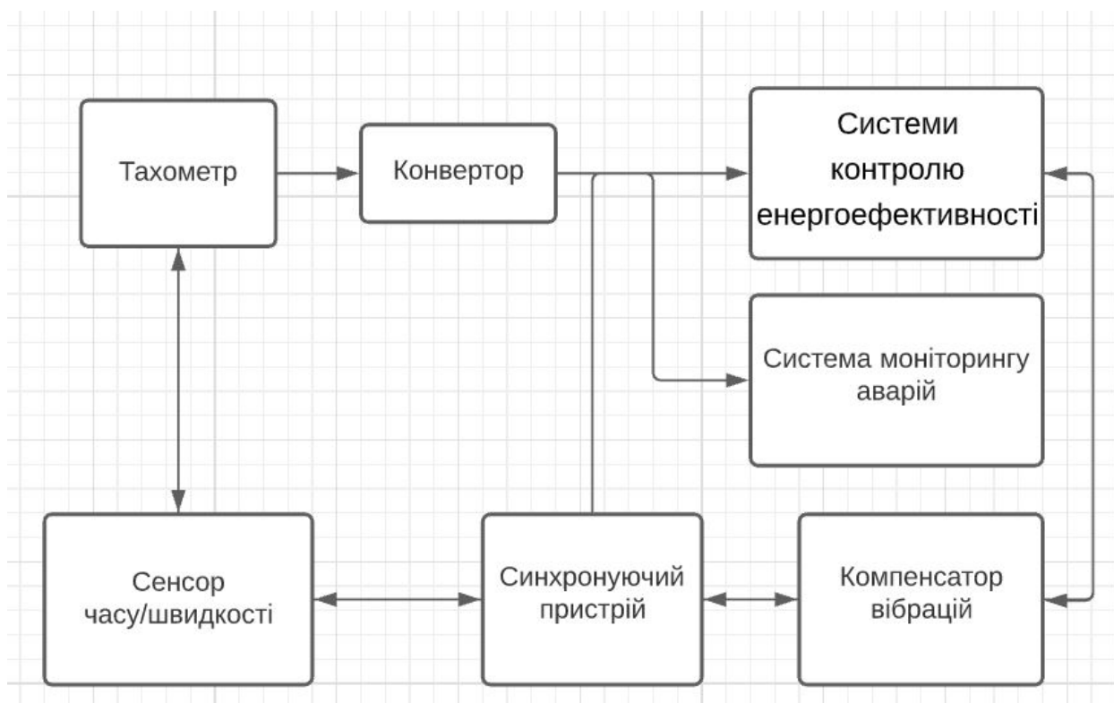
Рисунок 4.6 – Схеми роботи системи контролю ГД
