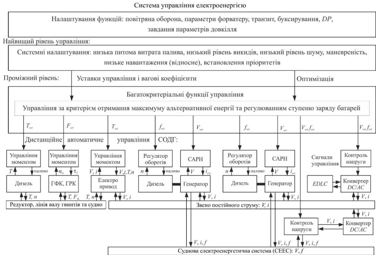
Рисунок 3.5 - Блок-схема стратегії управління СЕУ КПК за критерієм максимуму альтернативної енергії та регулювання ступеню заряду батарей СНЕ : САРН – система автоматичного регулювання напруги (англ. Automatic Voltage Regulator – AVR ); X_{set} – уставка; T – упор (момент); F – сила поштовху гвинта; f – частота напруги; V – напруга; n – частота обертання СОДГ ; i_{exc} – струм збудження генераторів; i – струм; \tau_T – результуюча проекції вектору зусилля на площину руху судна; \alpha_A – кут повороту ПП відносно діаметральної площини судна
