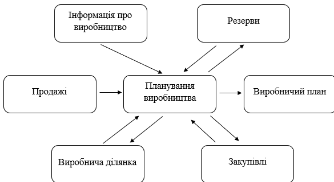
Рис 1.3. Принцип роботи системи MRP (Material Requirements Planning)
