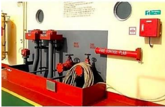
Рис. 4.1. Контейнер зі схемами з протипожежним захистом судна
