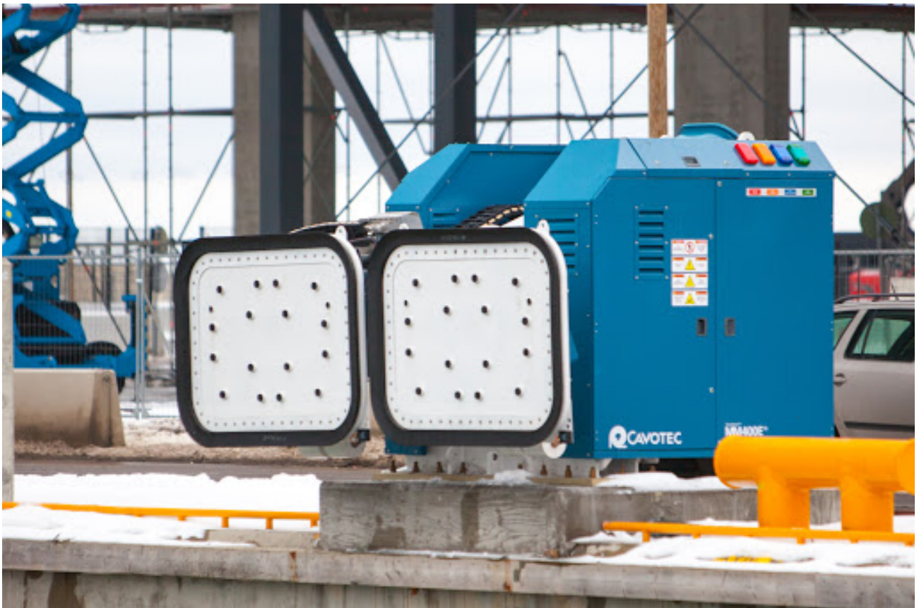
Рис. 2.6. Пристрої автоматичного швартування Megastar
