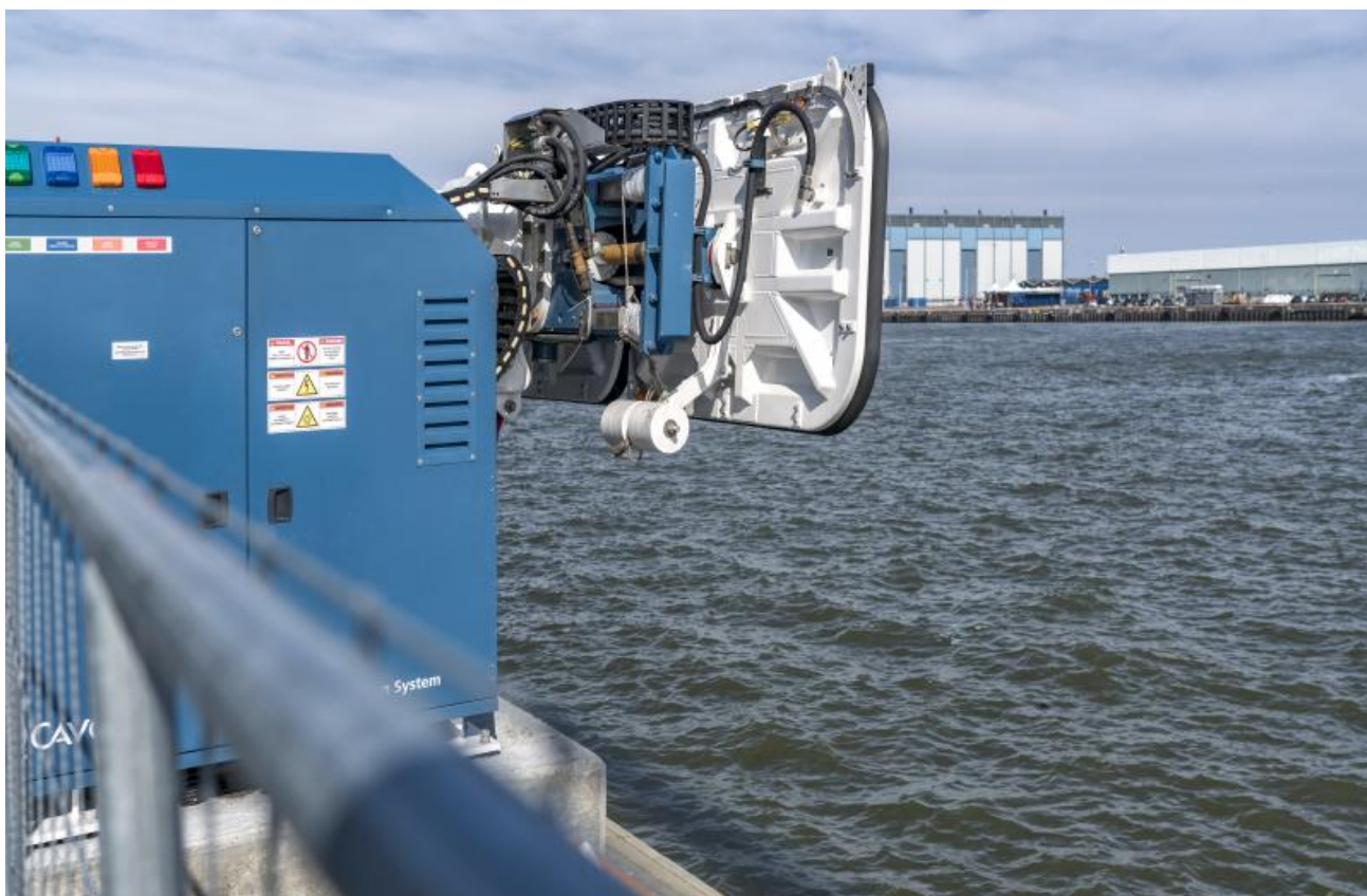
Рис.3.3. Автоматична вакуумна система швартування суден MoorMaster.
