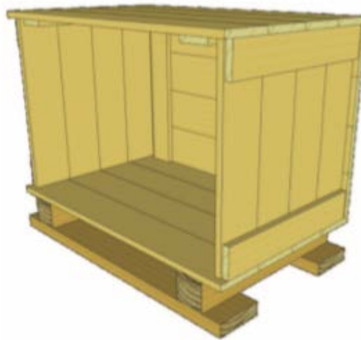
Рис. 3.1. Приклад формування крейт-модуля на піддоні Джерело: [55]
