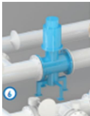
Рисунок 2.16 – Датчик провідності (CSU – Conductivity Sensor Unit)
