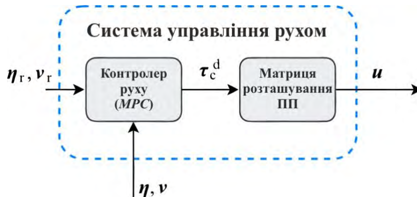
Рис. 4 Відокремлена система керування рухом
