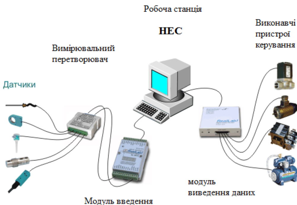
Рисунок 3.16 – Структурна схема процесу вимірювання параметрів СГД та контролю технічного стану за допомогою нечіткої експертної системи
