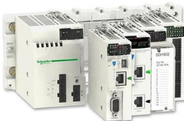
Рисунок 4.1 – Загальний вид ПЛК Modicon M340
