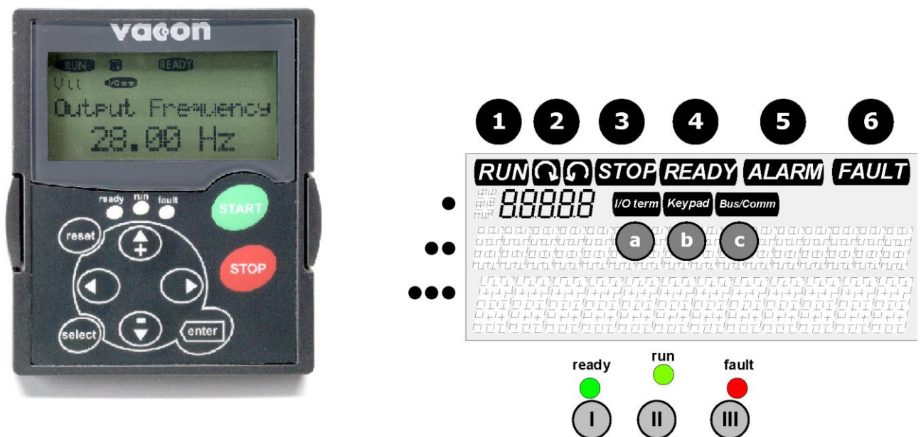
Рис. 2.3.1 - Панель управління ПЧ VACON NXP та індикатори стану привода
