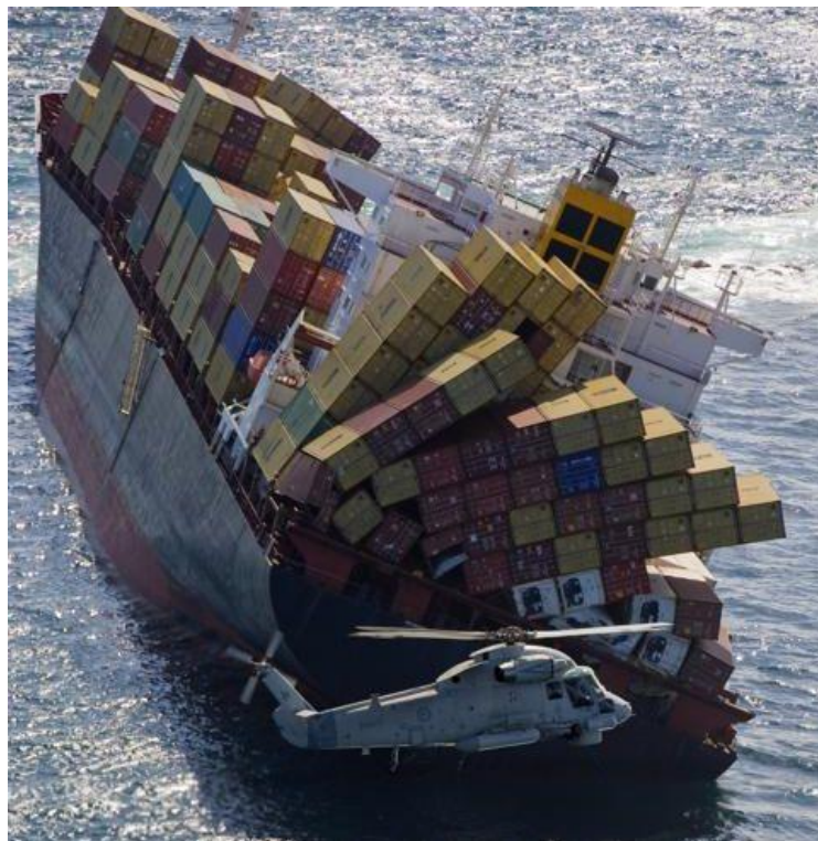
Рис. 5.1.1 – Зміщення вантажу на контейнеровозі
