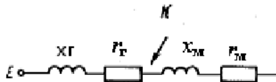
Рисунок 3.1 – Розрахункова схема для визначення струму КЗ
