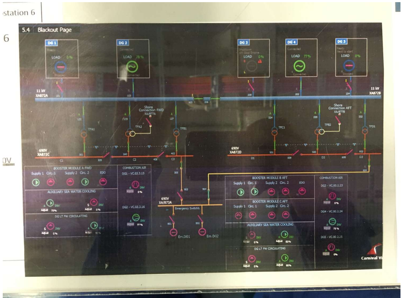
Рисунок 3.3. - Фрагмент схеми моніторингу параметрів СЕС (СДГ і АДГ)
