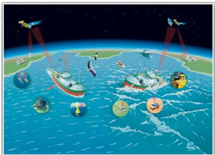
Рисунок 4.4 – Система супутникового угруповання КОСПАС-САРСАТ.
