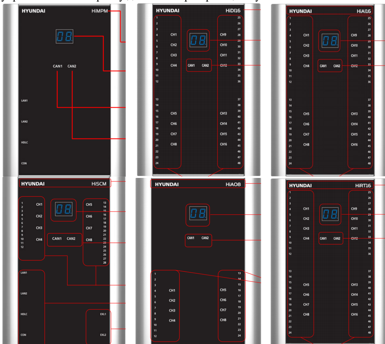
Рисунок 4.2 – Модулі Human Interface Aconis DS.
