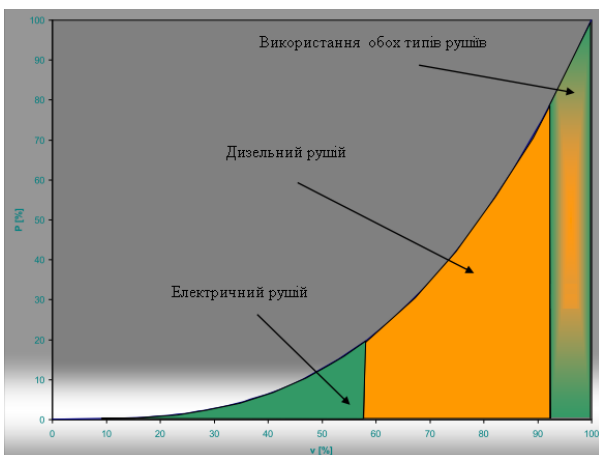
Рисунок 3 – Допустимі межі використання електричного, дизельного і дизель-електричного типів рушіїв
