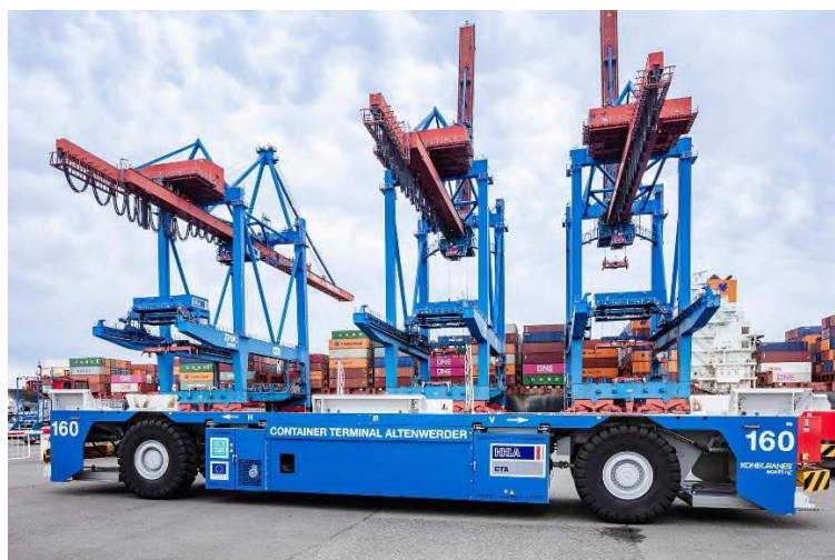
Рис. 1.7. Автоматизований керований транспортний засіб (AGV) на контейнерному терміналі Альтенвердер (СТА), Гамбург
