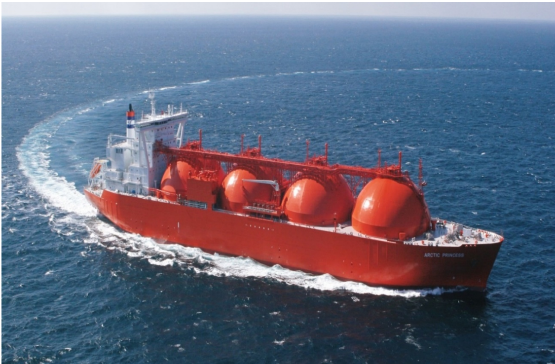
Рис. 3.4. Перевезення зрідженого природного газу газовозом в криостерні
