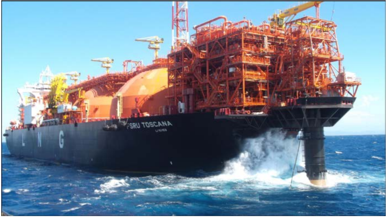
Рис. 3.6. Плавуча установка терміналу в Ліворно - FSRU Toscana
