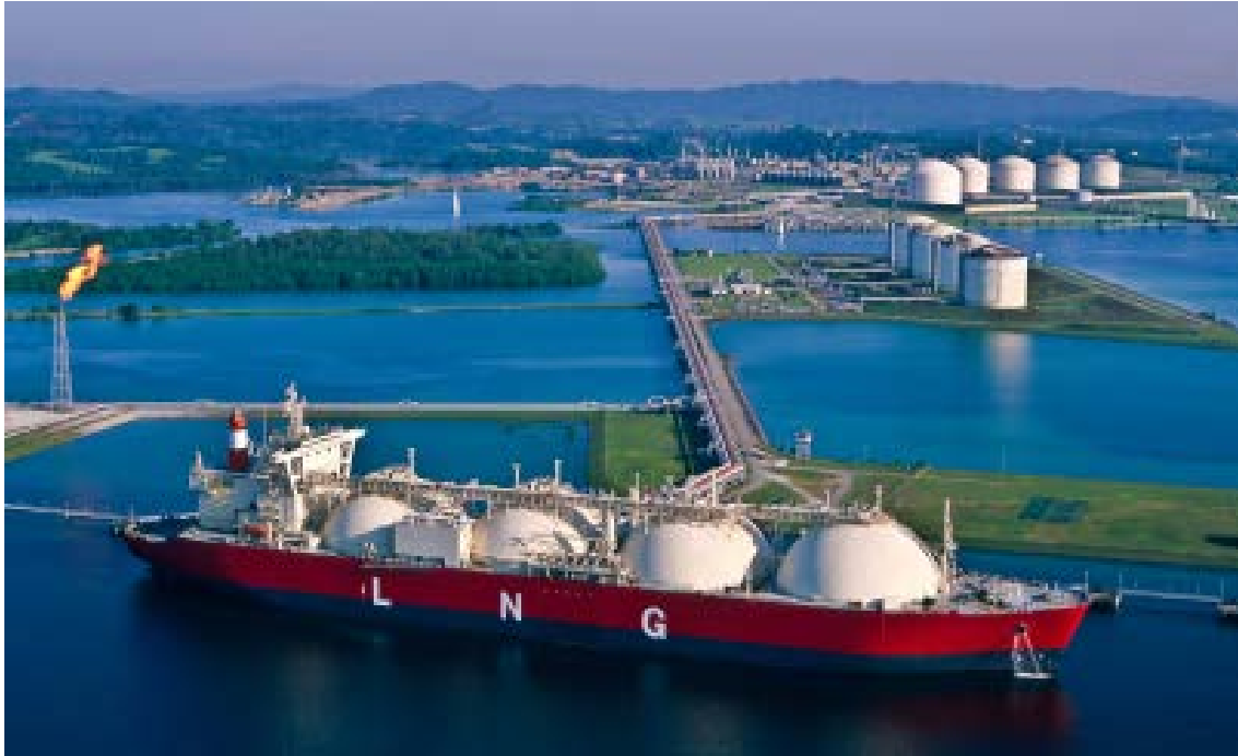
Рис. 3.3. LNG-танкер: судно газовоз для перевезення зрідженого природного газу
